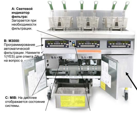
**D:** Выключатель: По одному для шкафа на каждом компьютере (только для версии для использования на внутреннем рынке).
